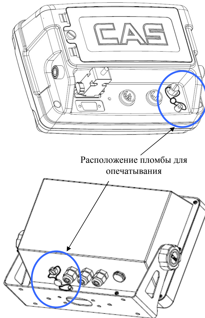
Рисунок 14.1 – Расположение поверочной пломбы индикатора
